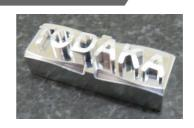
研磨 平面研磨での鏡面仕上げ
