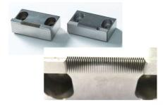
**ワイヤー放電**による くし歯加工 線径0.07mmのワイヤーで 微細加工が可能です
